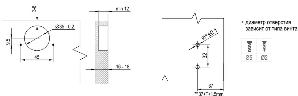
\* диаметр отверстия зависит от типа винта
