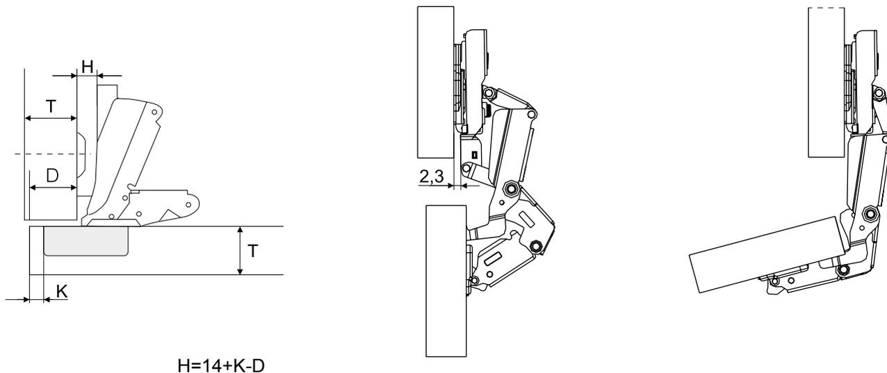
Используйте формулы для определения расчета расстояния до чашки петли (K) и высоты планки (H)
